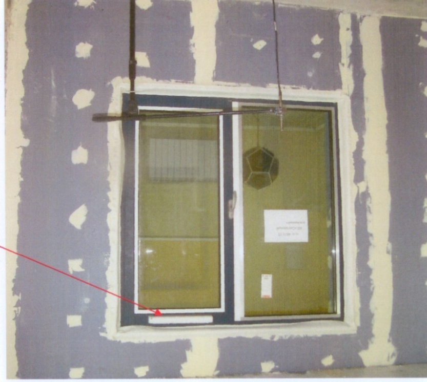
Фото 1. Камера низ. уровня, (испытание оконного блока пер. № 4621-21 в акустической камере)
